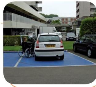
« Qu'elle soit à l'extérieur ou à l'intérieur du bâtiment, une place de stationnement adaptée doit se raccorder sans ressaut de plus de 2 cm au cheminement d'accès à l'entrée du bâtiment ou à l'ascenseur. Sur une longueur d'au moins 1,40 m à partir de la place de stationnement adaptée, ce cheminement doit être horizontal au dévers près. »
